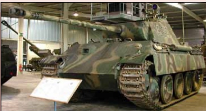
Panzermuseum Koblenz. Panther Ausf. G met Nachtsichtgerät. Afb.11-12. TvS7-8. FG1250 nachtsichtapparatuur met 600 m zicht bij heldere nacht. Een groot krachtig zoeklicht op een halfrups begeleide de Panther tanks voor nachtsicht op grotere afstanden.
