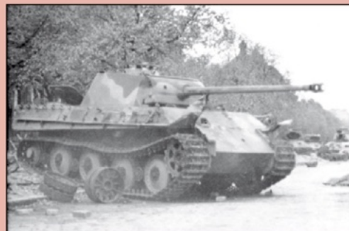
Berlijn 1945. Let op de loopwielen! Deze afbeelding toont een Panther Ausf. G zonder de buitenste loopwielen om hem maar zo snel mogelijk direct vanuit de Daimler-Benz fabriek Werk 40 te Berlijn-Marienfelde in de strijd te kunnen brengen.
