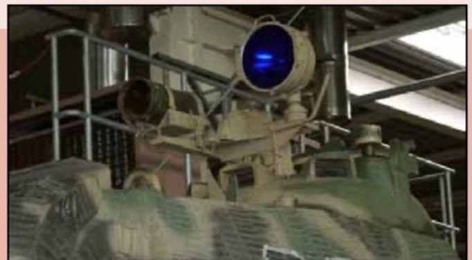
Panzermuseum Koblenz. Panther Ausf. G met Nachtsichtgerät. Afb.11-12. TvS7-8. FG1250 nachtsichtapparatuur met 600 m zicht bij heldere nacht. Een groot krachtig zoeklicht op een halfrups begeleide de Panther tanks voor nachtsicht op grotere afstanden.
